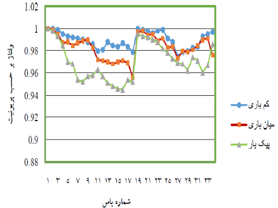
شکل (۱۳): پروفیل ولتاژ شبکه ۳۴ شینه در حالت خازن گذاری با الگوریتم پیشنهادی (CSA)
