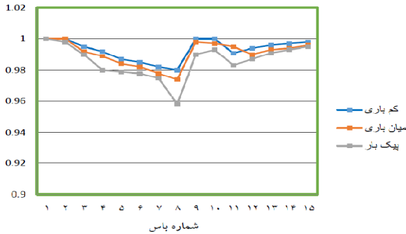
شکل (۷): پروفیل ولتاژ شبکه ۱۵ شینه در حالت خازن‌گذاری با الگوریتم پیشنهادی (CSA)
